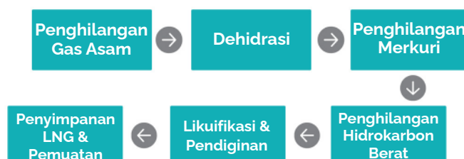
Gambar 2. Diagram sederhana rantai produksi LNG
